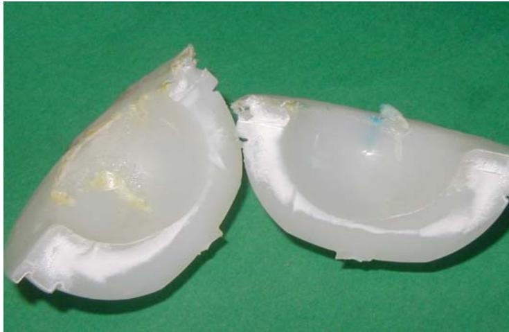
**Figura 2** - Ossidazione (aree bianche) su inserto in polietilene per protesi d'anca, sterilizzato con raggi  $\gamma$  in aria ed espantato dopo otto anni
