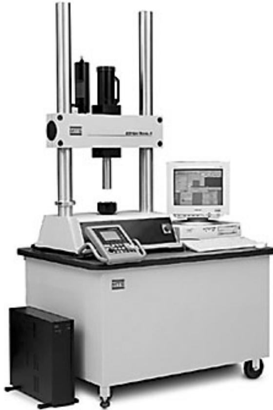
**Figura 1. Sistema servoidraulico per prove meccaniche a fatica**
