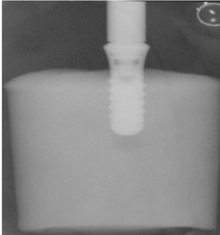
**Figura 4. Osservazione radiografica di un impianto dentale sottoposto alla prova meccanica a fatica**
