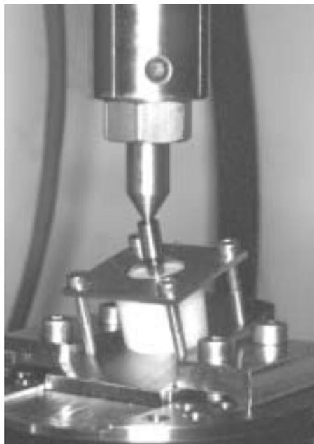
**Figura 2. Sistema di afferraggi realizzati per effettuare le prove meccaniche**
