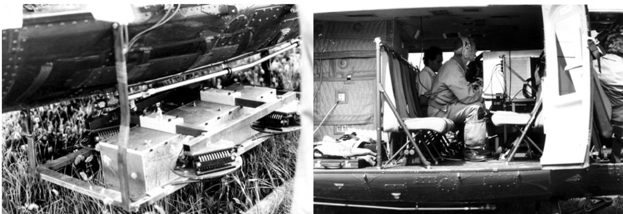
**Fig.1** A sinistra la struttura di sostegno del rivelatore NaI(Tl) alloggiato sotto la fusoliera dell’elicottero Agusta-Bell 412 che fu utilizzato ai tempi dell’incidente di Chernobyl e (a destra) la collocazione a bordo dello stesso elicottero della strumentazione di gestione e controllo del sistema.
