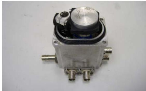
**Fig.6** Il Geiger ed il BGO lungo la linea di aspirazione del campione.
