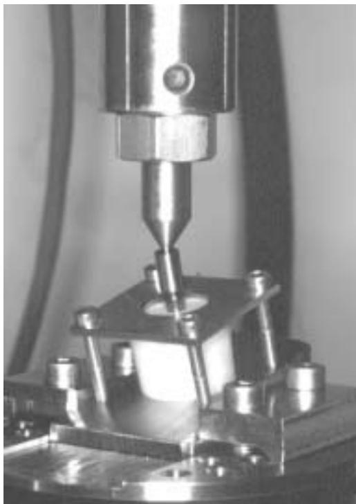
**Figura 2. Posizionamento del prototipo di impianto dentale nella strumentazione per le prove meccaniche a fatica**
