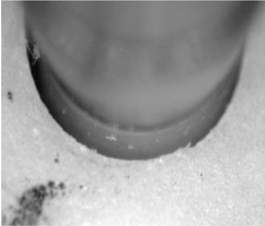
**Figura 5. Analisi microscopica che mostra i segni di compressione presenti su un prototipo dopo le prove meccaniche**
