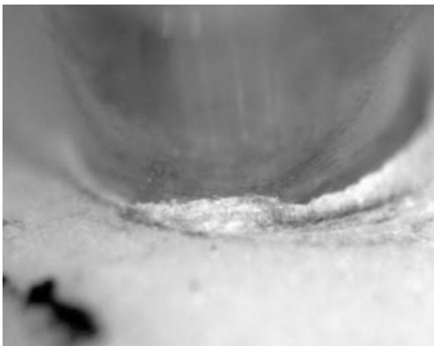
**Figura 4. Analisi microscopica dello spazio creatosi tra impianto e cemento in un prototipo dopo le prove meccaniche**
