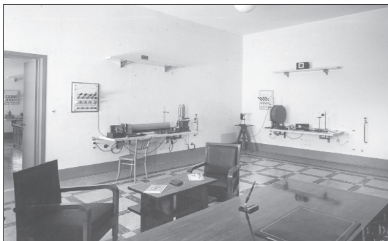
Figura 5 - Studio-laboratorio dei primi direttori del Laboratorio di Fisica. Si possono riconoscere: a destra una camera a ionizzazione ad aria libera e a sinistra un apparecchio per la taratura di preparati di radio molto attivi, costituito da un tubo di piombo con all'interno un carrello per posizionare il preparato a una opportuna distanza dall'elettrometro. Ambedue provenivano dall'Ufficio del Radio (archivio fotografico ISS).
