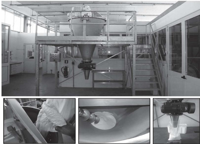
**Figura 1. Impianti ENEA Centro Ricerche Trisaia per l'omogeneizzazione dei materiali in batch e la preparazione di lotti omogenei**
