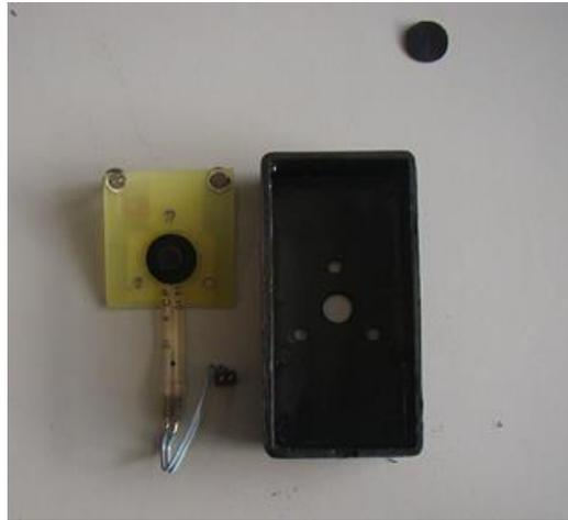
**Figura 3. Contapassi basato sull'espansione del gastrocnemio (GEMU): dettagli sul posizionamento dell'FSR**
