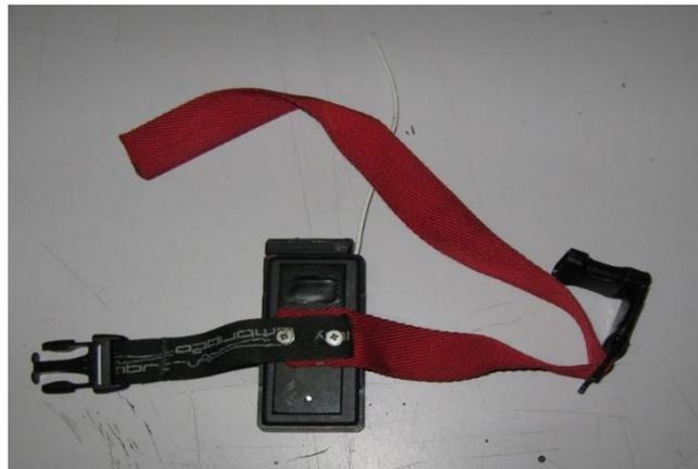
Figura 10. Contapassi basato su accelerometro per studi di comparazione
