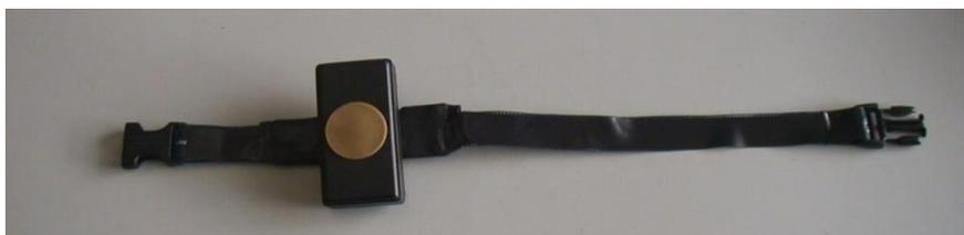
**Figura 5. Contapassi basato sull'espansione del gastrocnemio (GEMU): sensore e cinghia**
