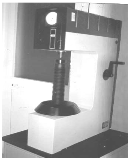
Figura 2. Strumentazione per eseguire le prove di durezza
