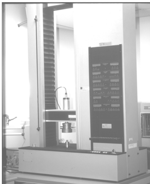
Figura 3. Dinamometro elettronico utilizzato per le prove di compressione
