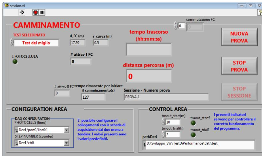
Figura 6. Finestra di avvio test, impostazione dei parametri
