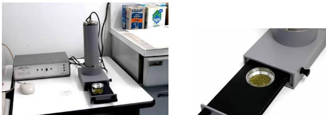
Figura 6. Sistema di misura PSL (a destra il cassetto estraibile con l'alloggiamento per la capsula Petri contenente il campione)
