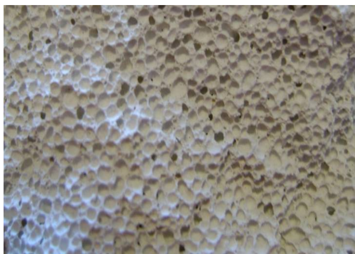
Figura 9. Particolare delle celle chiuse dell'interno del pannello
