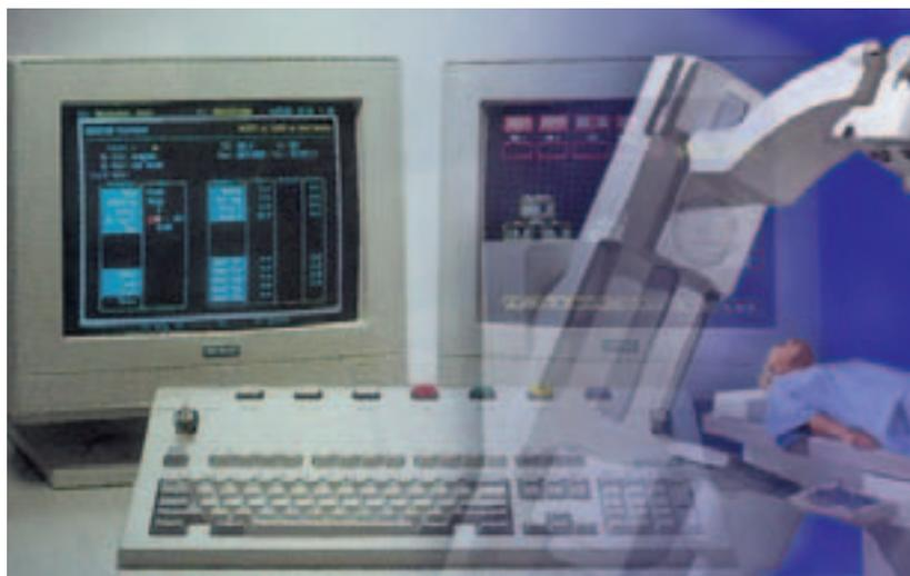
**Figura 4** - I sistemi per la pianificazione del trattamento sono costituiti da un software altamente specialistico che permette di calcolare e visualizzare la distribuzione di dose che si vuole somministrare al paziente
