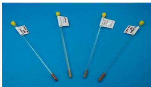
Figura 7. Tubi utilizzati per l'inserimento dei campioni nella cavità risonante
