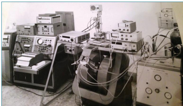
**Figura 7** - Spettrometro EPR modificato per la rivelazione di transizioni superconduttive, con metodologie a sensibilità di fase, in funzione del campo magnetico e della temperatura (al centro, il magnete con il criostato all'interno delle sue espansioni polari e il ponte a microonde).
