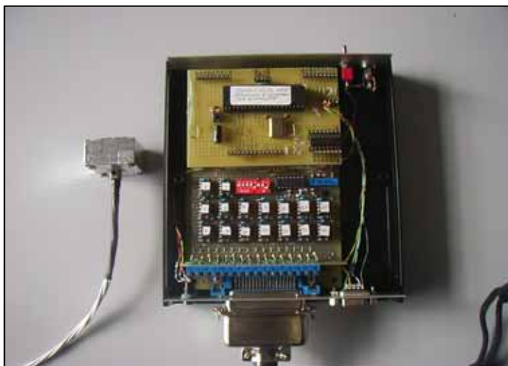
Figura 11. Vista su un'unità di servizio aperta e un'unità odoscopio
