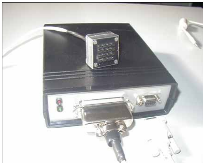
Figura 13. Unità odoscopio e di servizio (dettagli interfaccia PC)
