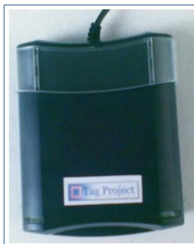
Figura 6 - Lettore/scrittore RFID palmare
