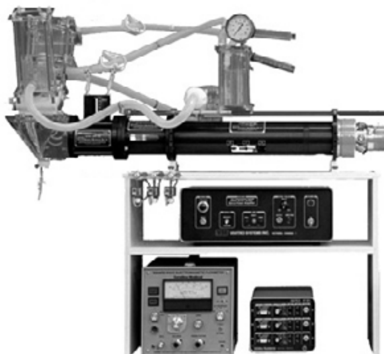
Figura 1. Visione d'insieme del banco di lavoro utilizzato dall'Istituto Superiore di Sanità per la certificazione e la ricerca sulle valvole cardiache protesiche
