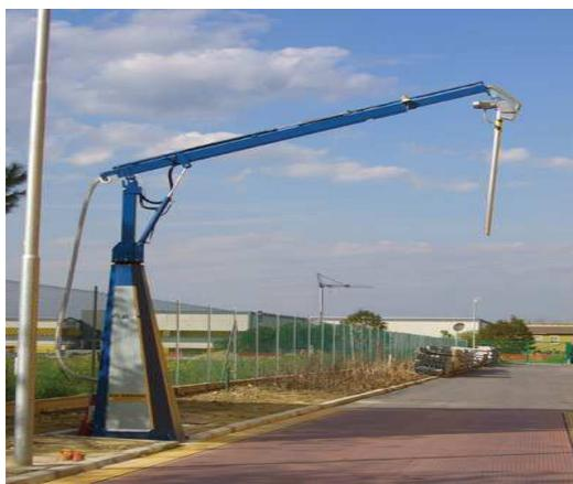
Figura 1. Sonda preleva campioni automatica
